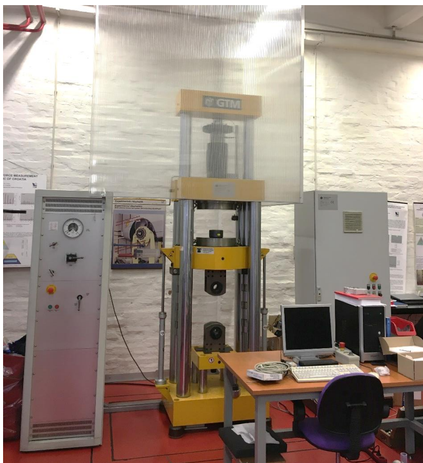
Slika 5. Referentni etalon sile 500 kN u LIMS-u, FSB, Hrvatska
