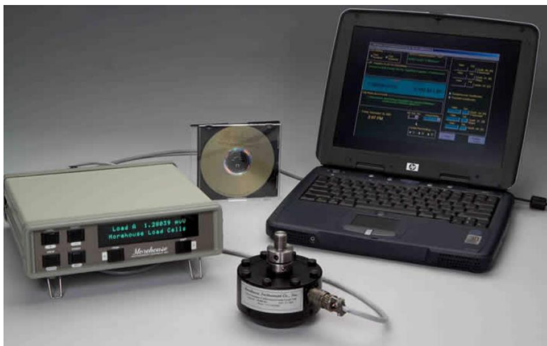
Slika 6. Prijenosni etalon sile s kompletnom opremom [6]
