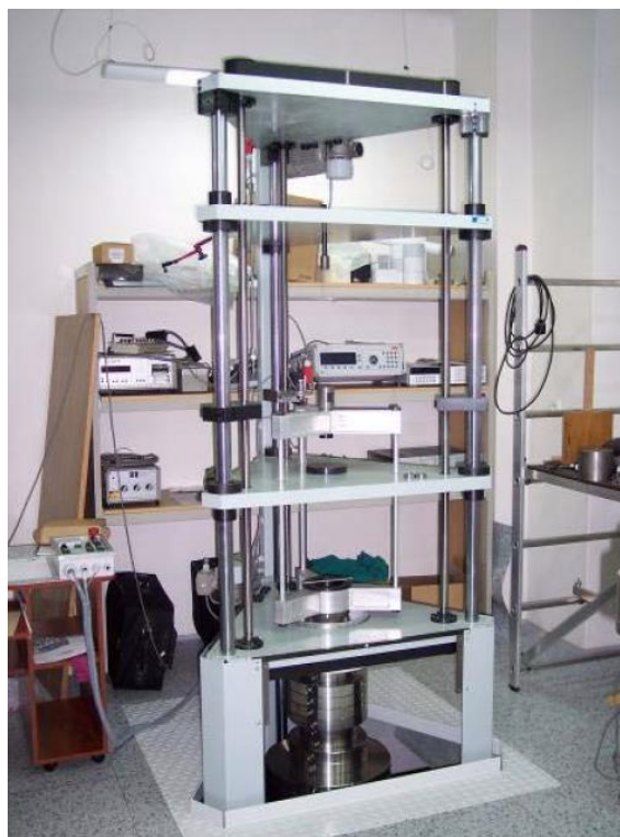
Slika 20. Nacionalni etalon ESZ 20kN [12]
