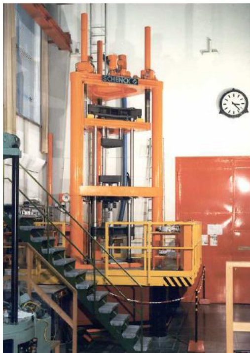
Slika 4. Primarni - nacionalni etalon sile 1 MN u PTB-u, Njemačka [6]
