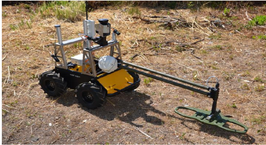
Slika 1 Primjer mobilnog robota za detekciju mina
