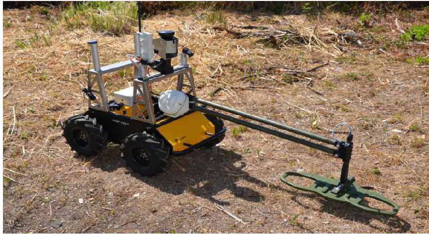
Slika 1 Primjer mobilnog robota za detekciju mina
