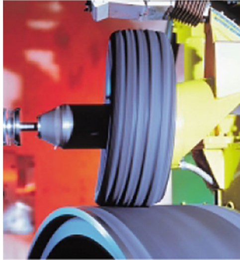
Slika 1.3: Slika postava za testiranje gume
