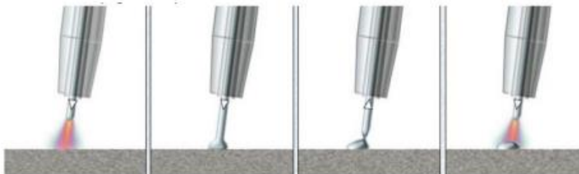
Slika 12: Gibanje žice za vrijeme CMT postupka zavarivanja [10]
