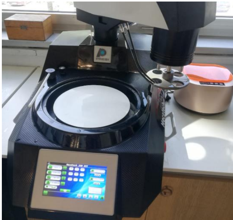
Slika 47: Stroj za brušenje makrouzoraka Mecatech 250 SPI
