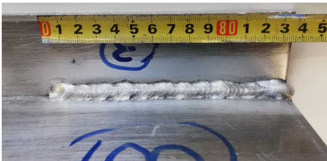
Slika 42: Uzorak 3 (Balans postavljen na +30)
