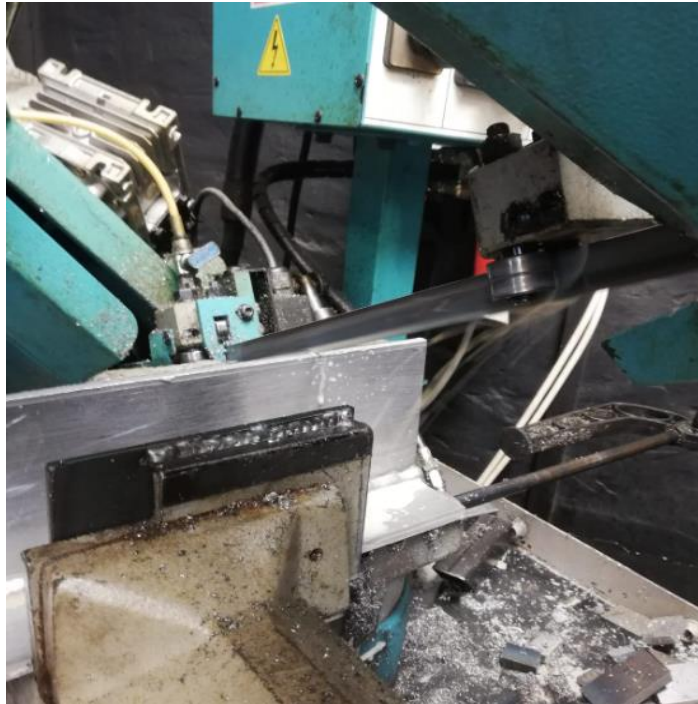
Slika 45: Rezanje uzoraka na pili BS 350 GH
