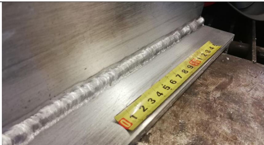
Slika 56: Zavareni T spoj
