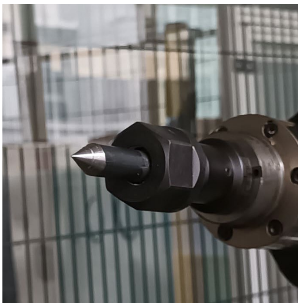
Slika 19. Šiljak stegnut u steznu čeljust motorvretena
