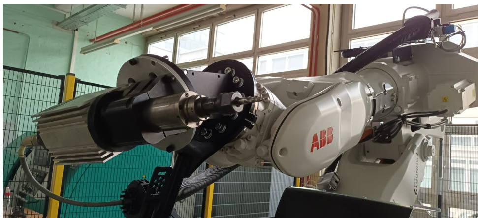
Slika 17. Montirane prirubnice s motorvretenom na robotsku ruku
