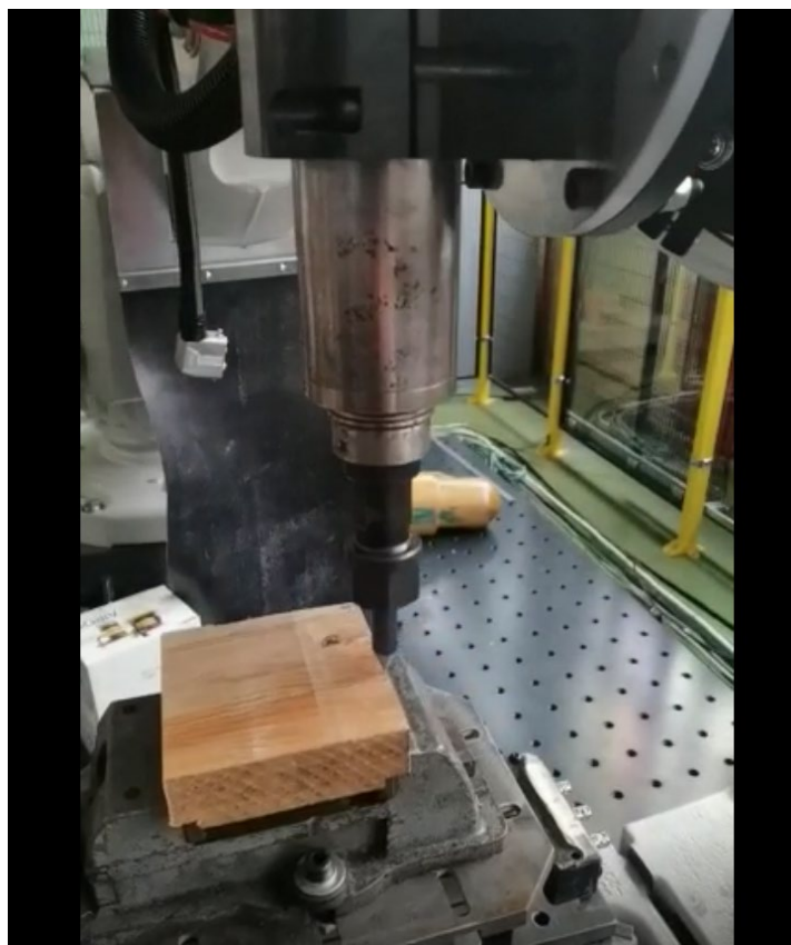
Slika 24. Vođenje šiljka po rubnoj konturi pripremk
