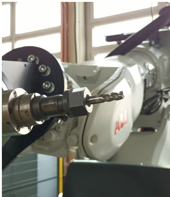
Slika 26. Glodalo stegnuto u steznu čahuru motorvretena
