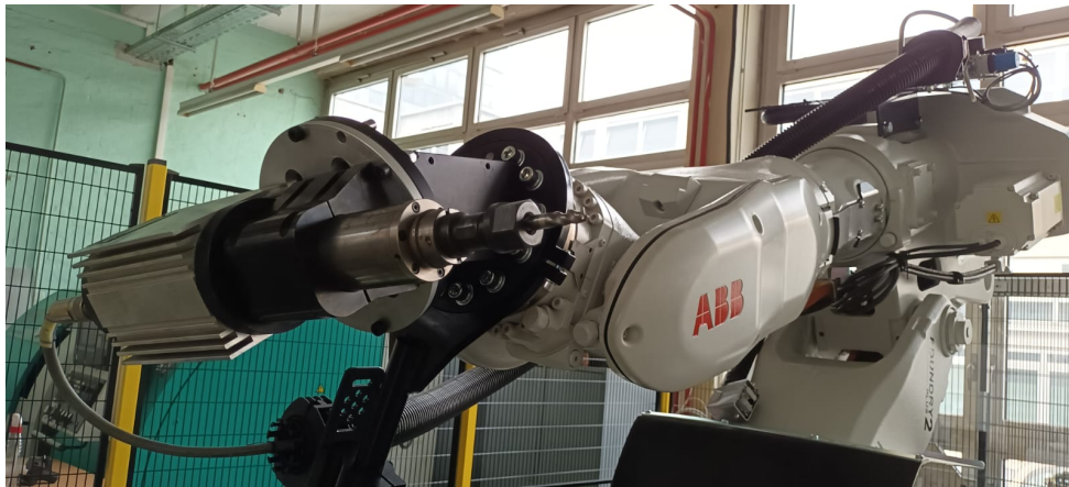
Slika 17. Montirane prirubnice s motorvretenom na robotsku ruku
