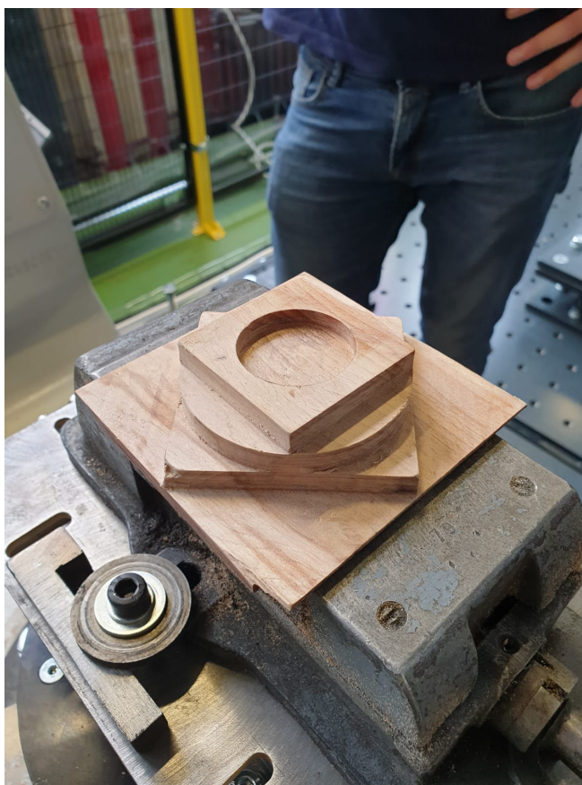
Slika 27. Rezultat obrade drvenog komada
