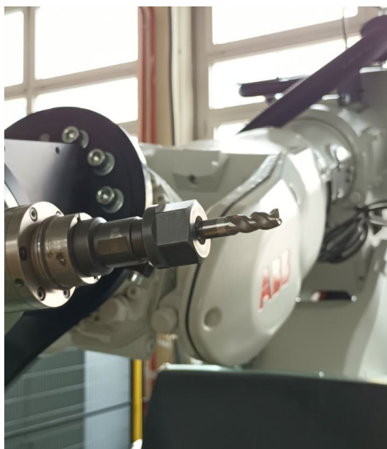
Slika 26. Glodalo stegnuto u steznu čahuru motorvretena
