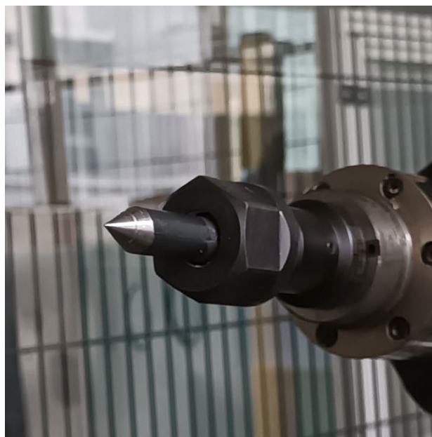
Slika 19. Šiljak stegnut u steznu čeljust motorvretena
