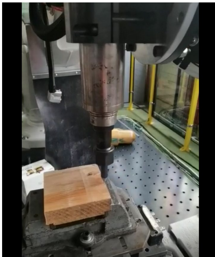
Slika 24. Vođenje šiljka po rubnoj konturi pripremka
