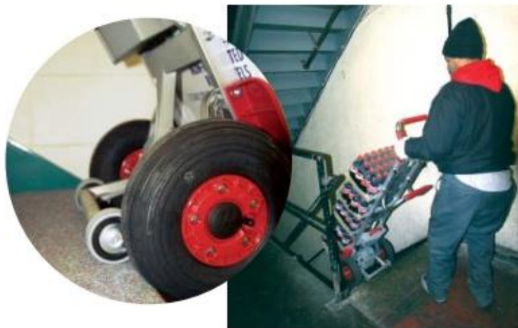
Slika 11. Ručni viličar s pogonom za stepenice
