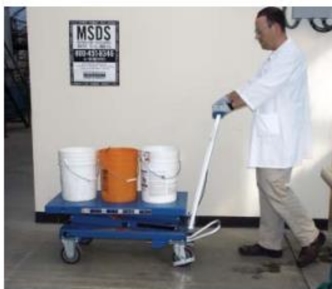
Slika 13. Kolica s kočnicom i mogućnošću podizanja tereta
