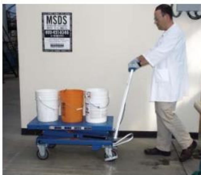
Slika 13. Kolica s kočnicom i mogućnošću podizanja tereta
