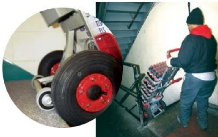
Slika 11. Ručni viličar s pogonom za stepenice
