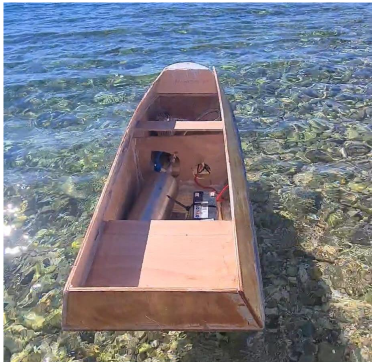
Slika 5.7. Konačan izgled sustava prilikom testiranja
