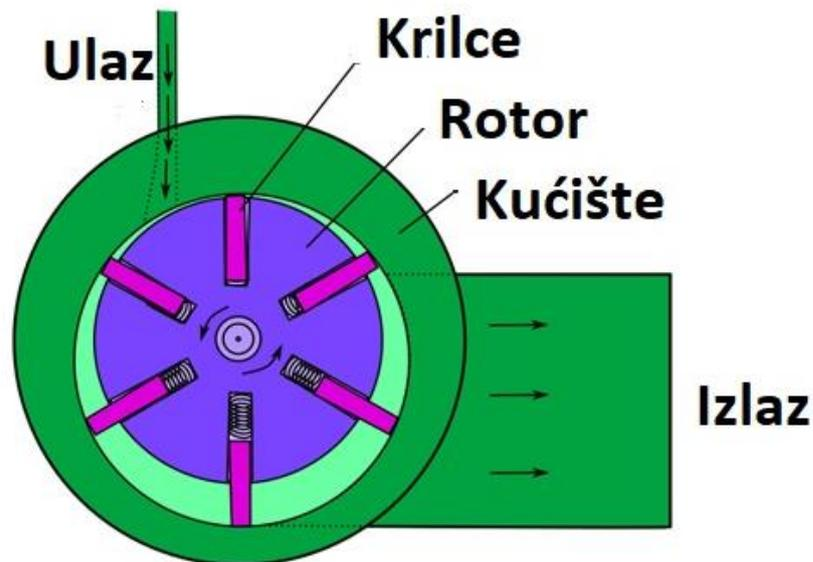
Slika 4.1. Zračni motor s rotirajućim krilcima [10]
