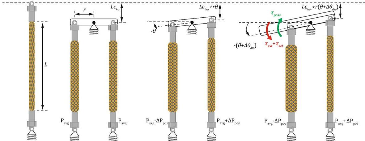
Slika 3.4. Princip rada sustava za skretanje [13]
