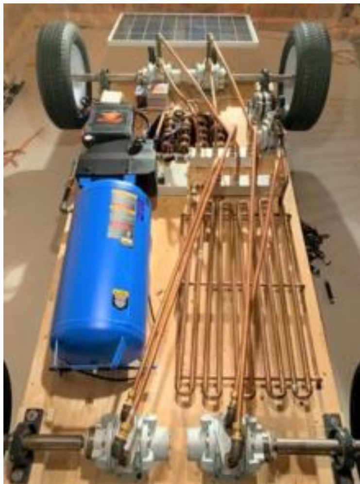
Slika 1.1. Prototip sustava stlačenog zraka s izmjenjivačem topline [2]
