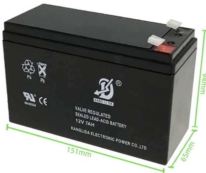
Slika 5.3. Izvor napajanja i dimenzije baterije
