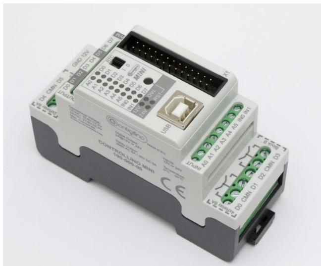
Slika 5.1. Upravljački uređaj Controllino Mini
