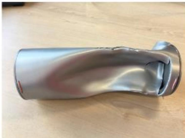
**Slika 2.1. Uništeni aluminijski tank na 1000m dubine [4]**
