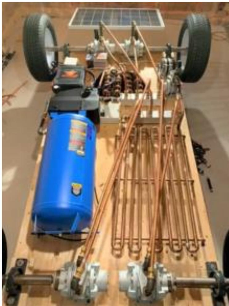
Slika 1.1. Prototip sustava stlačenog zraka s izmjenjivačem topline [2]
