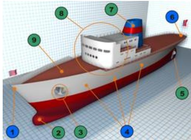
Slika 2.4. Dijelovi broda [7]
