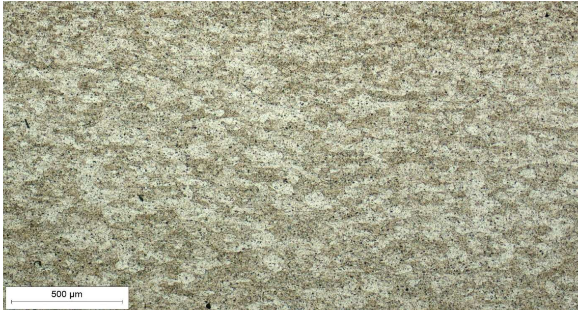
Slika 25. Mikrostruktura poprečnog presjeka lima okomito na smjer valjanja, snimljeno pri povećanju 50×
