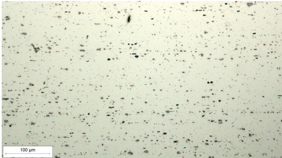
Slika 21. Mikrostruktura poprečnog presjeka lima, paralelno sa smjerom valjanja
