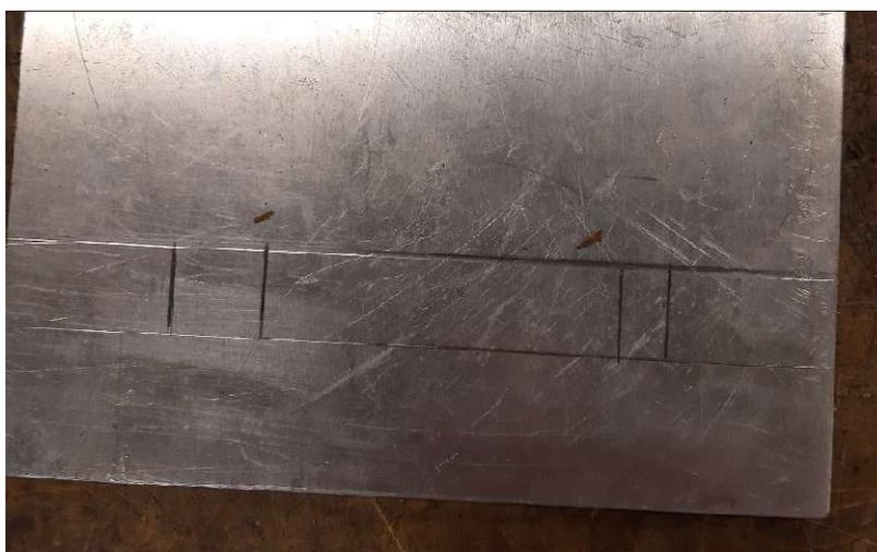
**Slika 18. Pozicija uzoraka za analizu mikrostrukture**
