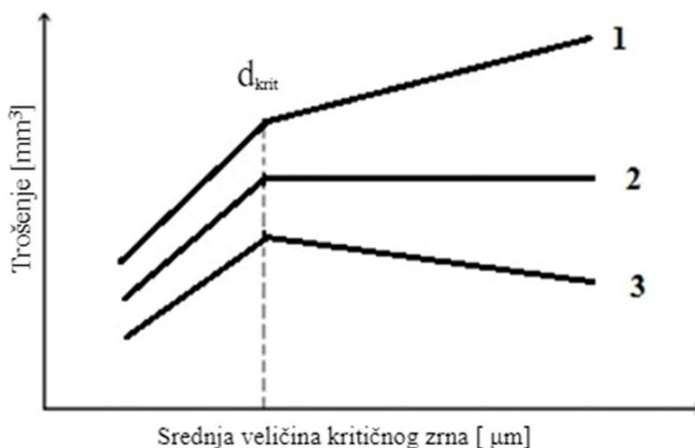
Slika 13. Utjecaj veličine abrazivnog zrna na abrazijsko trošenje [6]
