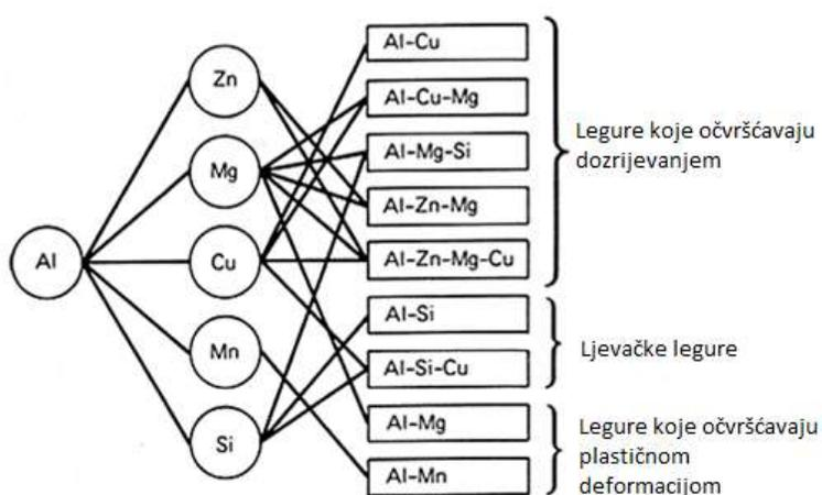
Slika 1. Aluminijeve legure koje se najčešće primjenjuju [2]
