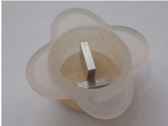
**Slika 19. Izrezani uzorci u kalupu prije zalijevanja**
