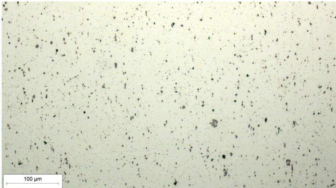
Slika 22. Mikrostruktura poprečnog presjeka lima, okomito na smjer valjanja
