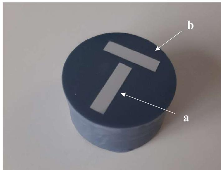
**Slika 20. Uzorci u smoli nakon brušenja i poliranja**
