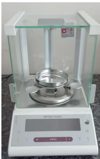
Slika 27. Uređaj za mjerenje mase
