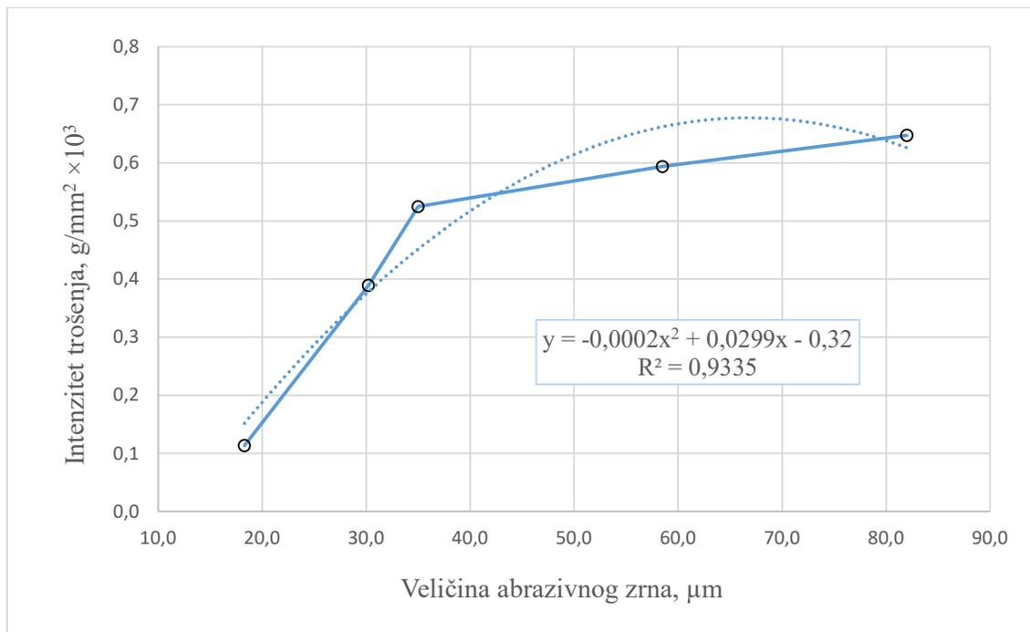
**Slika 32. Ovisnost intenziteta trošenja o veličini abrazivnog zrna**
