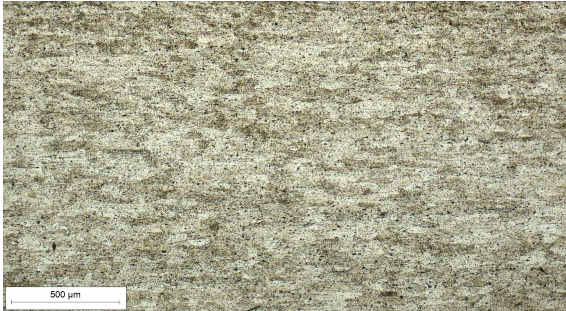
Slika 23. Mikrostruktura poprečnog presjeka lima paralelno sa smjerom valjanja, snimljeno pri povećanju 50×
