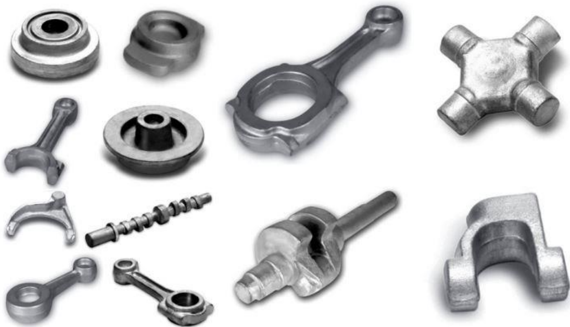
Slika 4. Proizvodi izrađeni toplim kovanjem [7]
