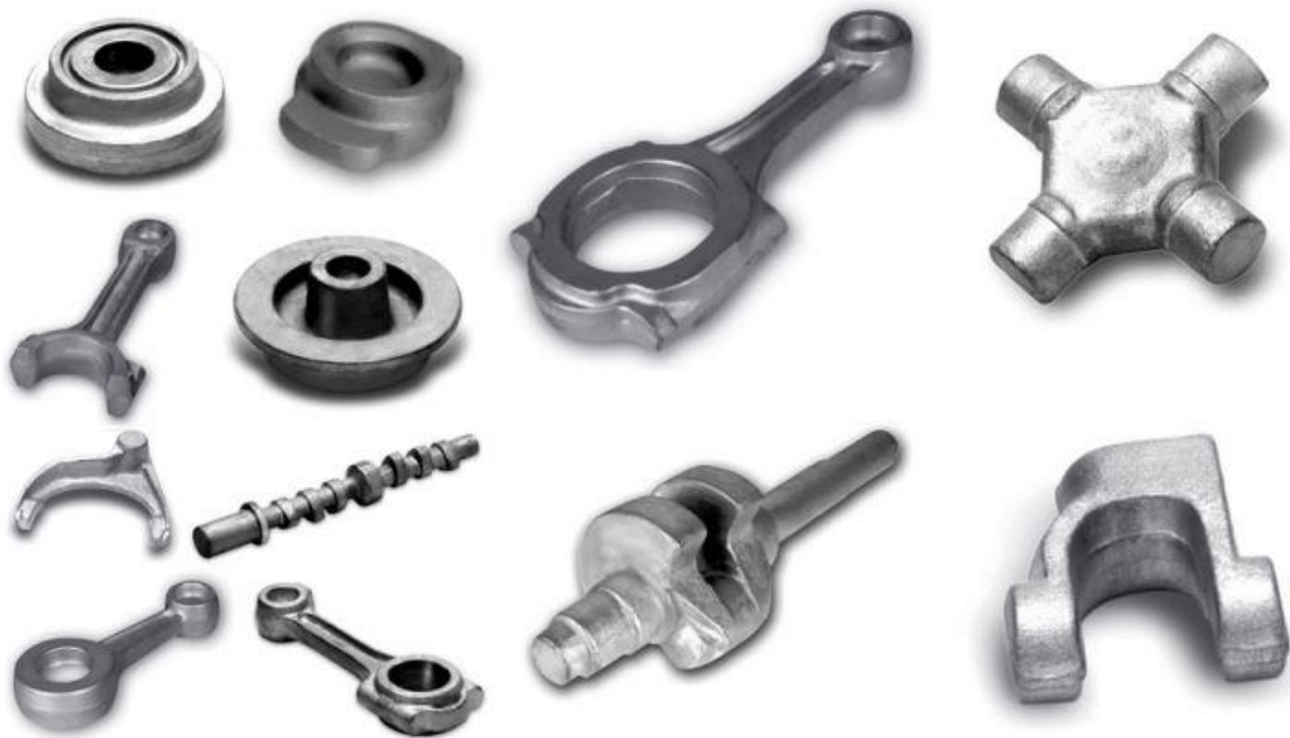
Slika 4. Proizvodi izrađeni toplim kovanjem [7]
