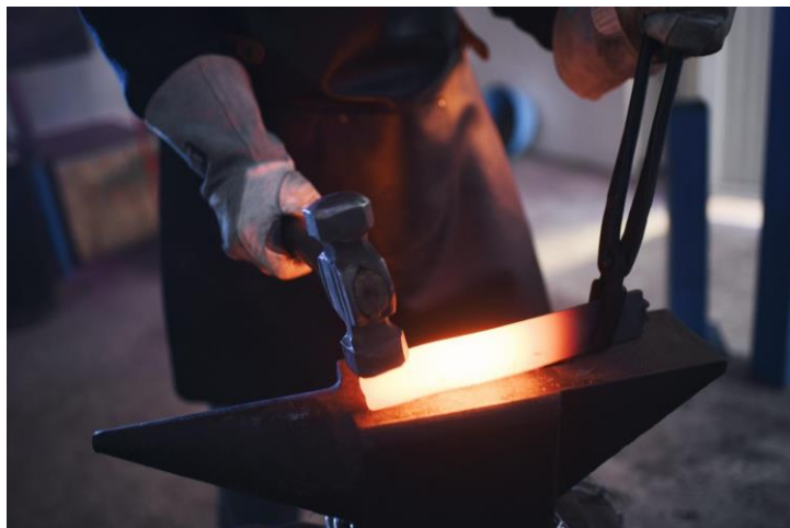
Slika 1. Slobodno kovanje u kovačnici [1]
