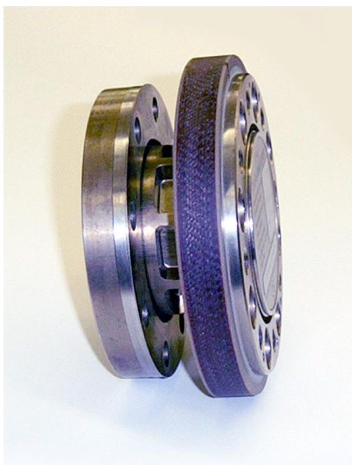
Slika 11: Tijelo HBK modela T10FS [1]
