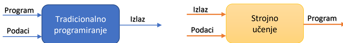
Slika 2.1. Usporedba tradicionalnog programiranja i strojnog učenja
