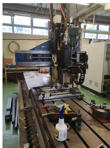
**Slika 24. Laboratorijska CNC glodalica**
