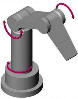
Slika 2.5. Rotacijska struktura robota
