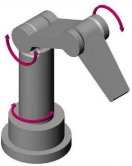
Slika 2.5. Rotacijska struktura robota
