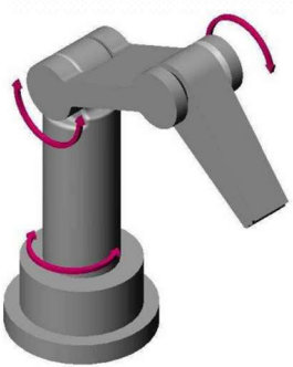
Slika 2.5. Rotacijska struktura robota
