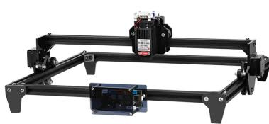
Slika 1.3: Stroj za lasersko graviranje twotrees TT-50 [6]
