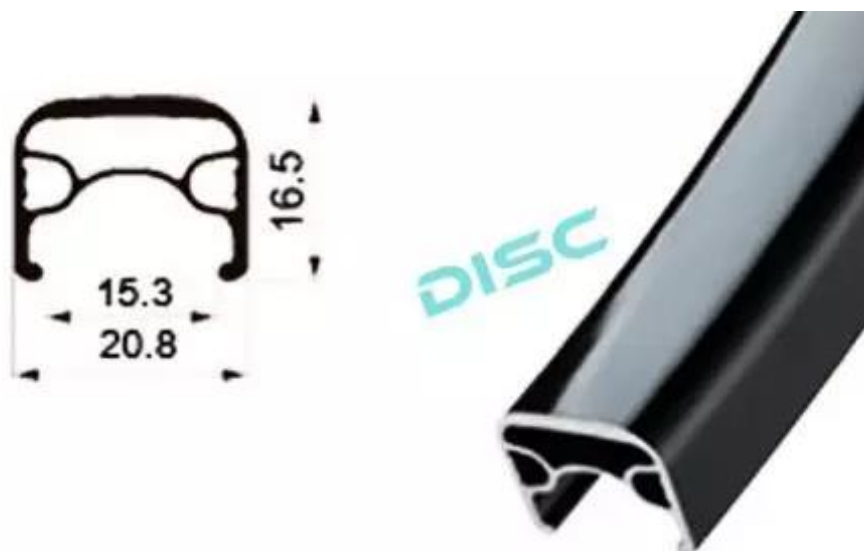
Slika 41. Odabrani profil za obruč kotača [22]
