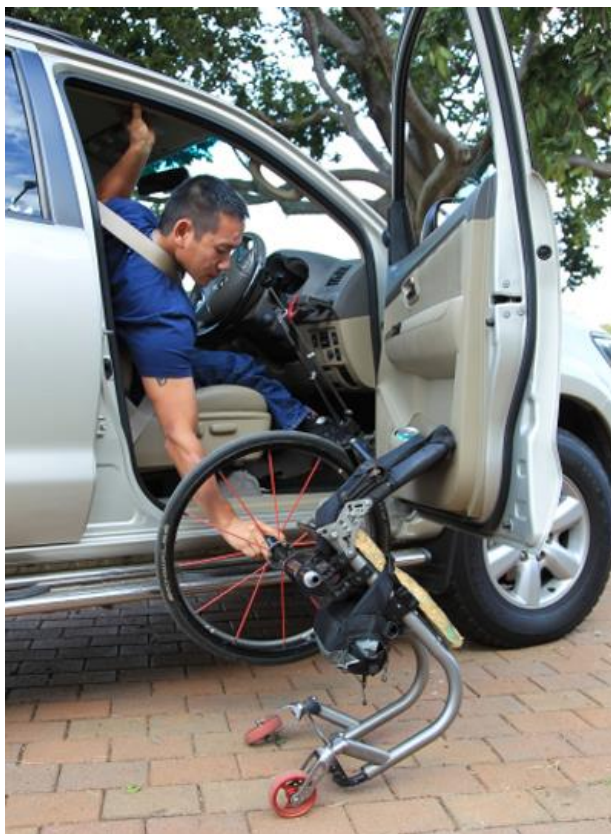
Slika 9. Odvajanje kotača od okvira [5]
