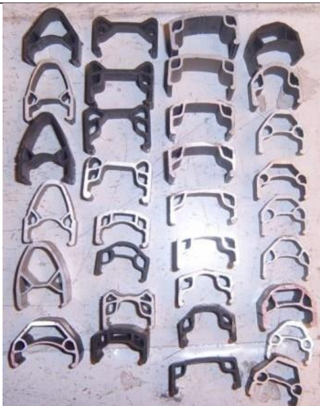
Slika 40. Različiti profili za obruč kotača [21]
