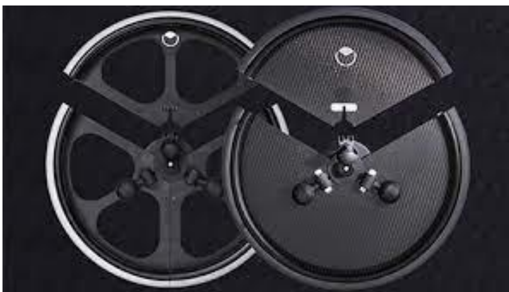
Slika 21. Trivida kotač, plastični (lijevo), karbonska vlakna (desno) [14]
