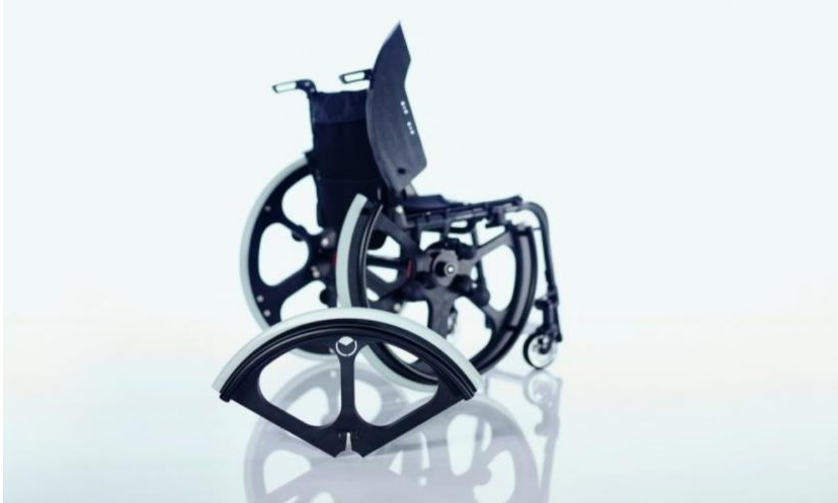
Slika 22. Odvojivi segment Trivida kotača na invalidskim kolicima [15]
