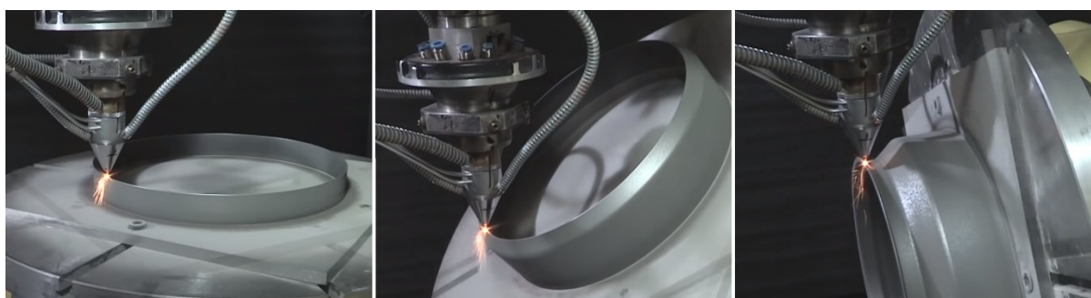
Slika 2.10. Pozicioniranje pomoću višeosnog okretnog stola [18]
