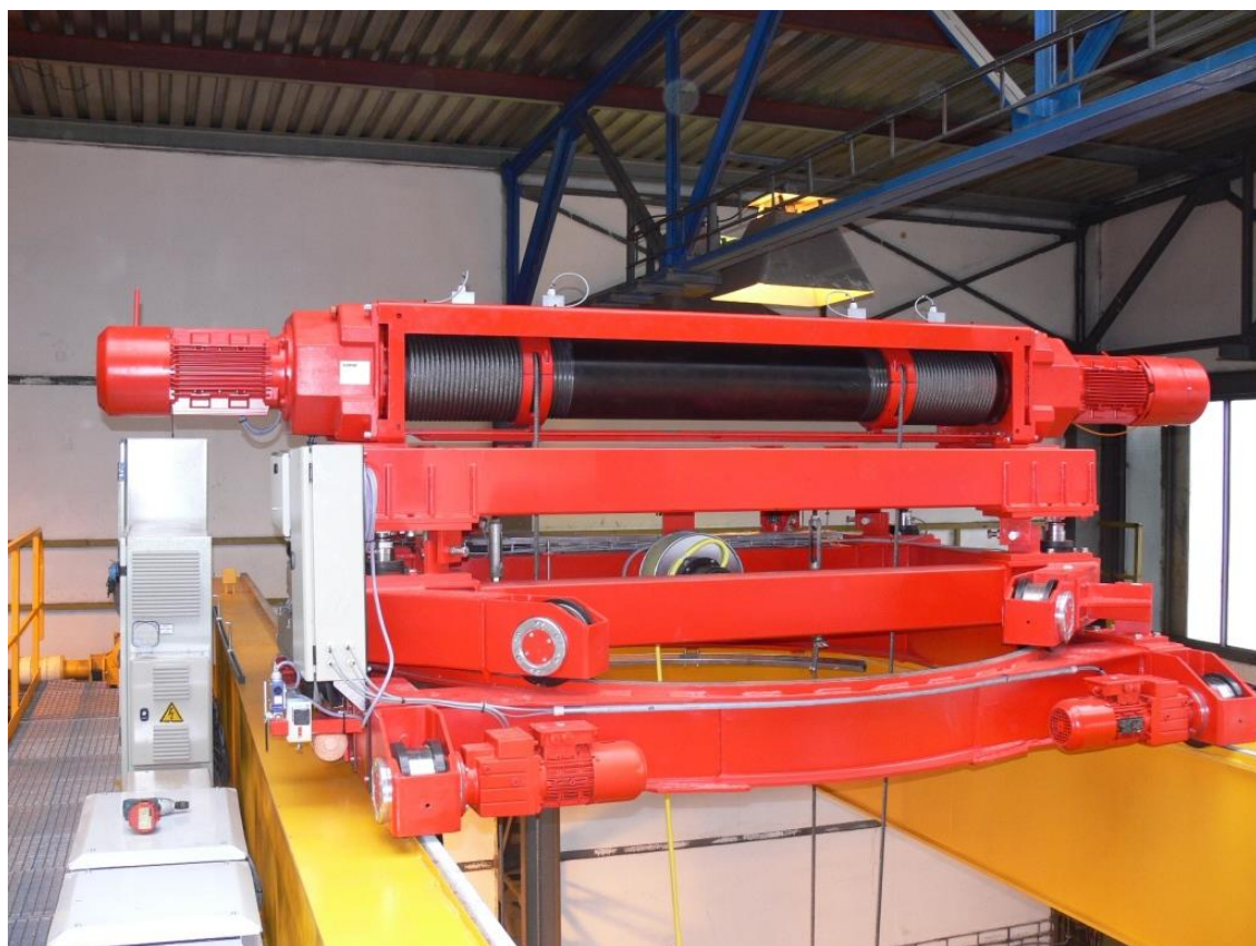
Slika 8. Sklop vozička tvrtke Giga [8]
