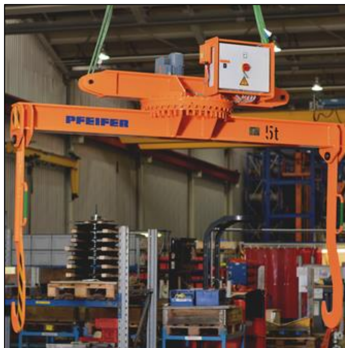
Slika 4. Rotirajući sustav pomoću zakretnog ležaja tvrtke Pfeifer [6]
