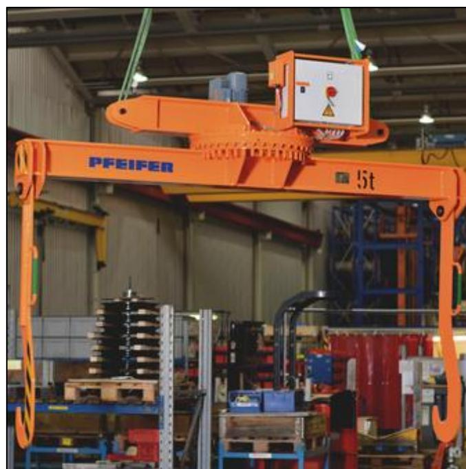
Slika 4. Rotirajući sustav pomoću zakretnog ležaja tvrtke Pfeifer [6]
