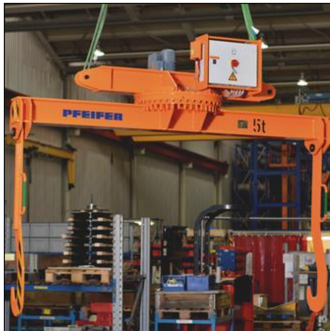
Slika 4. Rotirajući sustav pomoću zakretnog ležaja tvrtke Pfeifer [6]
