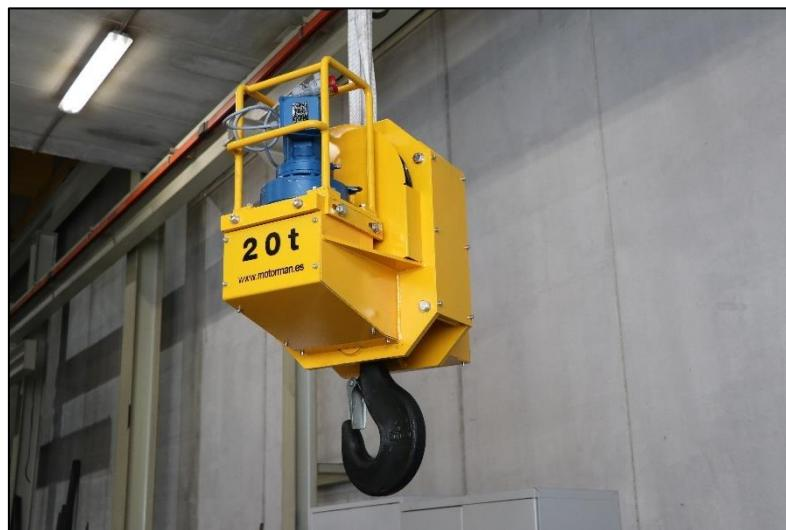
Slika 3. Sklop kuke s motoriziranim rotacijom tvrtke Motorman S.A. [5]
