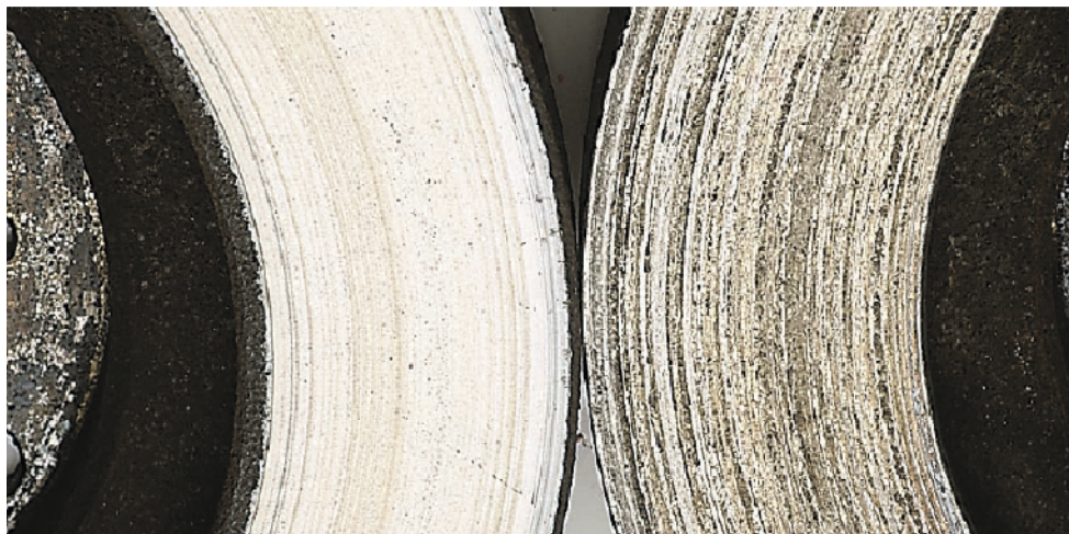
Slika 3.9. Usporedba tretiranog(lijevo) i netretiranog(desno) diska iz istraživanja objavljenog u časopisu [24]
