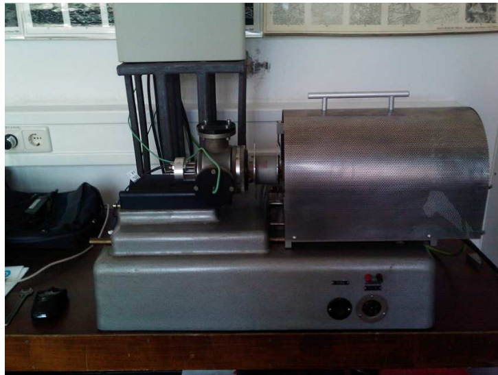
Slika 5.7. Modernizirani dilatometar A.D.A.M.E.L. DP55
