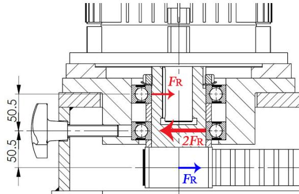
Slika 5.3: Sile na vratilo pogonske remenice
