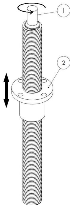
Slika 1.1: Pojednostavljeni prikaz gibanja navojnog vretena i maticе
