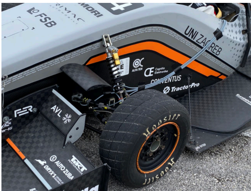
Slika 3.1. Tenzometri na bolidu VulpesR
