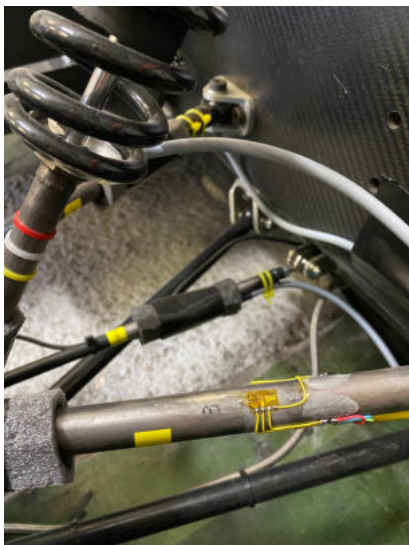
Slika 4.20. Mjerna mjesta postavljena na bolid 1
