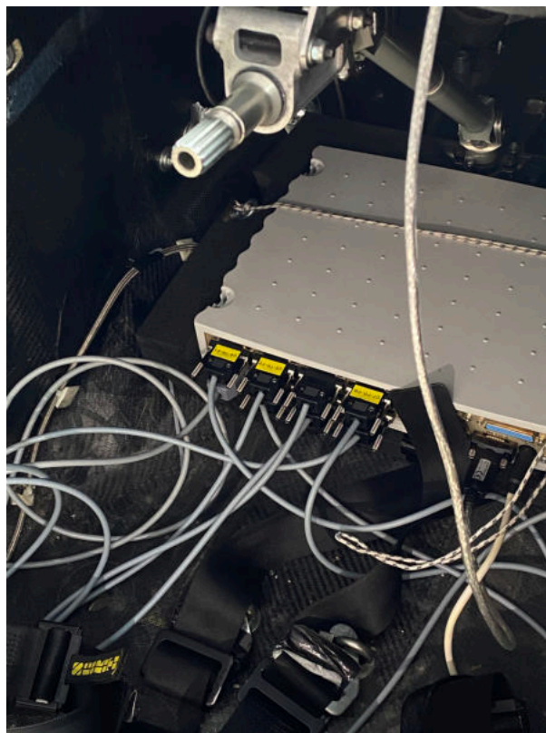
Slika 4.24. Pozicija mjerne opreme u bolidu
