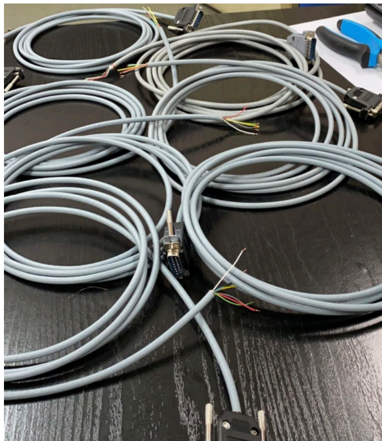
Slika 4.15. Priključni šesterožilni kablovi
