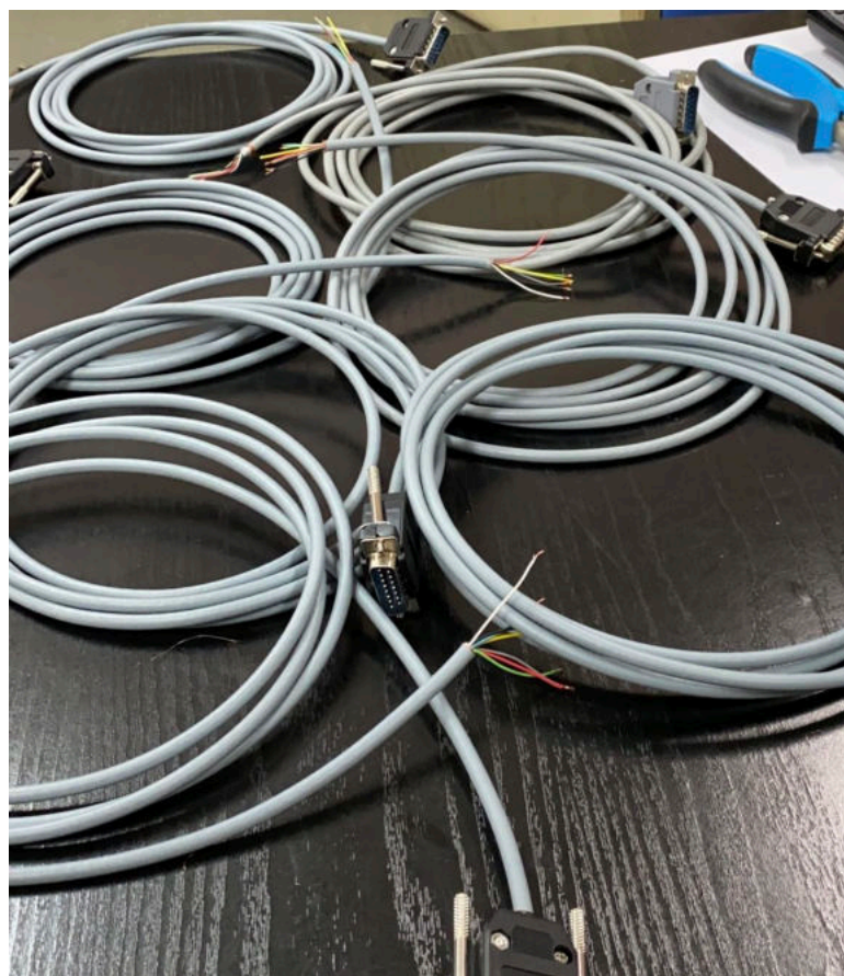
Slika 4.15. Priključni šesterožilni kablovi
