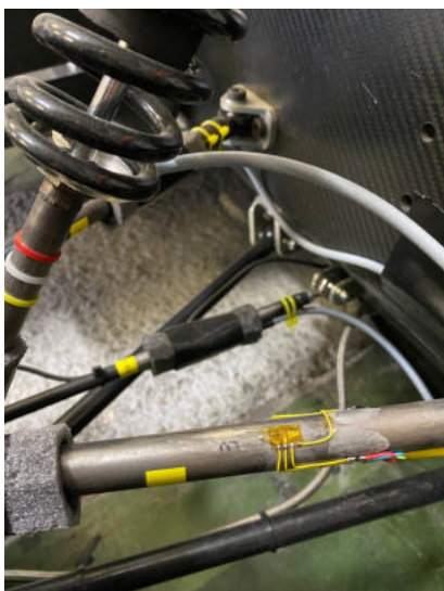
Slika 4.20. Mjerna mjesta postavljena na bolid 1
