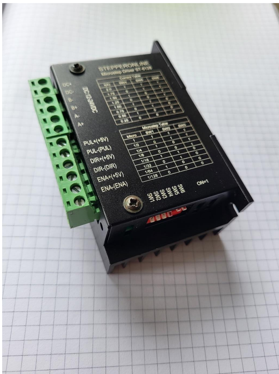
Slika 7. Driver koračnog motora
