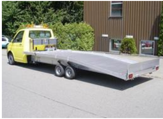
Slika 33. Aluminijska konstrukcija platforme na vozilu N1 kategorije [10]
