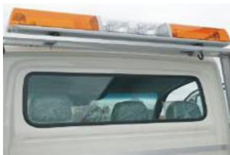
Slika 13. Rotacijska svjetla na transportnom vozilu [9]
