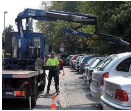
Slika 16. Bočno utovarivanje vozila uz korištenje hidrauličkih stabilizatora [18]
