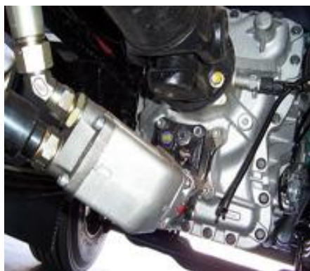
Slika 11. Hidraulička pumpa priključena na PTO spojkku [20]
