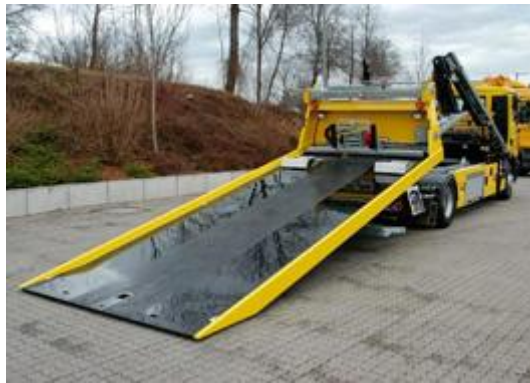
Slika 34. Čelična konstrukcija platforme na vozilu N2 kategorije [10]
