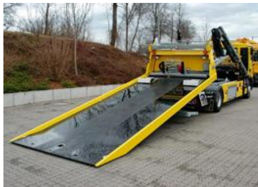
Slika 34. Čelična konstrukcija platforme na vozilu N2 kategorije [10]
