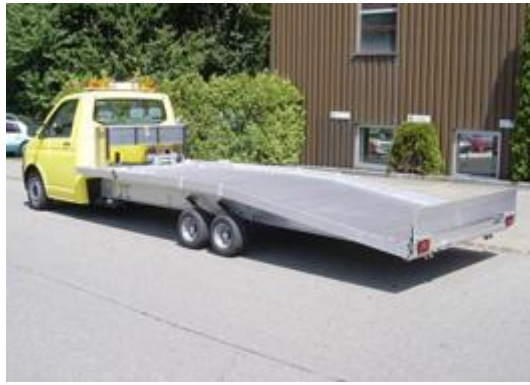
Slika 33. Aluminijska konstrukcija platforme na vozilu N1 kategorije [10]
