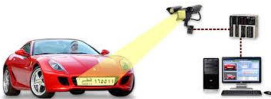
Slika 2 . Shematski prikaz rada ANPR-a
