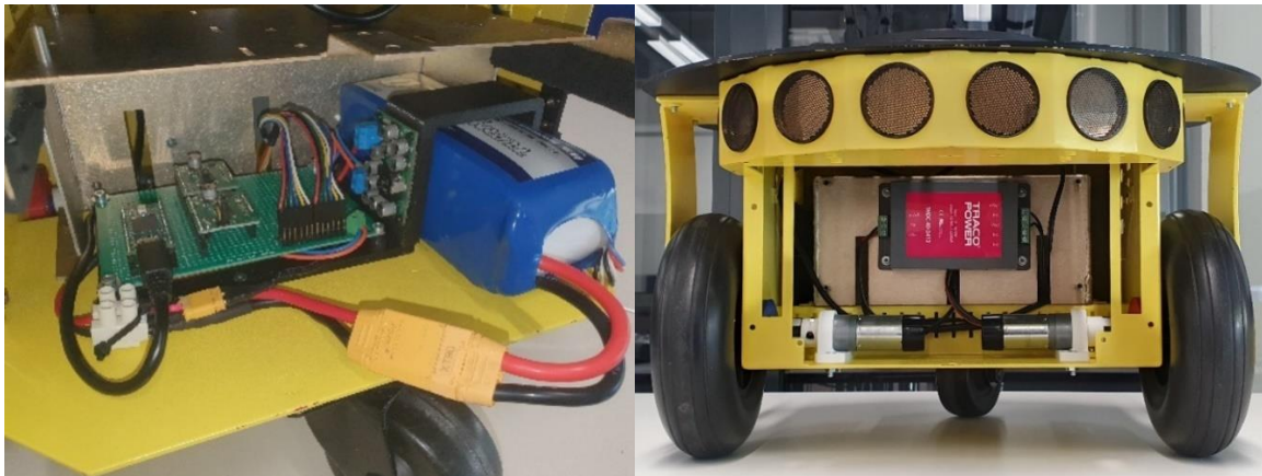
Slika 66. Upravljački sustav na mobilnom robotu
