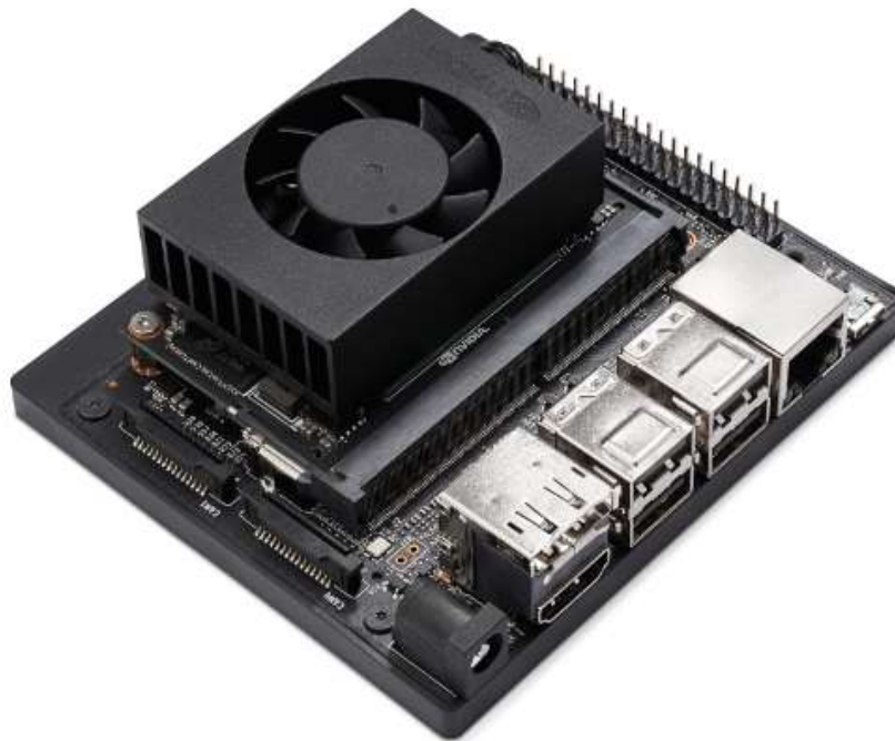
Slika 35. NVIDIA Jetson Xavier NX razvojni komplet[6]
