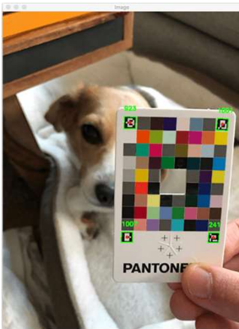
Slika 31. Prikaz detektiranih ArUco markera [26]
