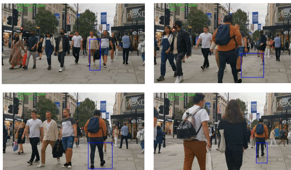
Slika 23. Praćenje osobe pomoću GOTURN algoritma praćenja [18]
