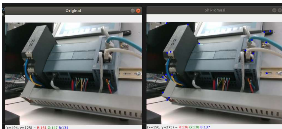
Slika 9. Primjer otkrivenih kutova Shi-Tomas algoritmom
