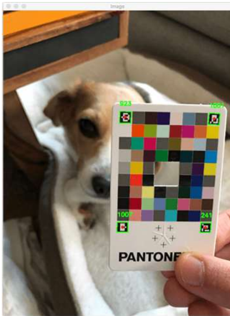
Slika 31. Prikaz detektiranih ArUco markera [26]
