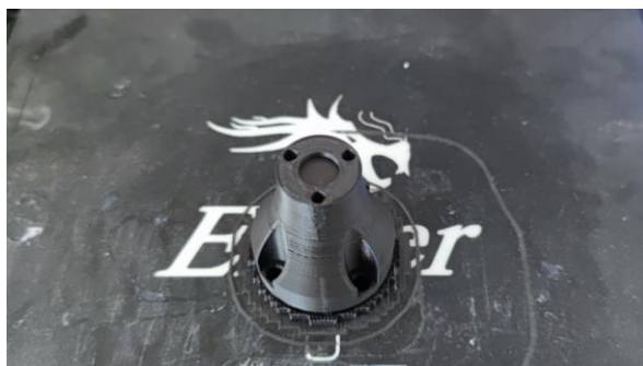
Slika 13. Gotov model držača hvataljke
