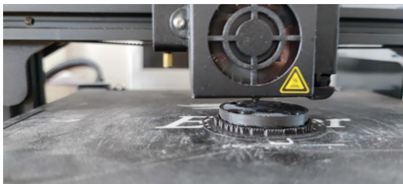
Slika 12. Početak ispisa držača hvataljke
