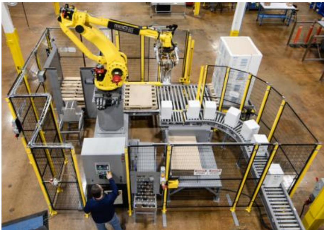
Slika 3. Automatiziran proces paletizacije
