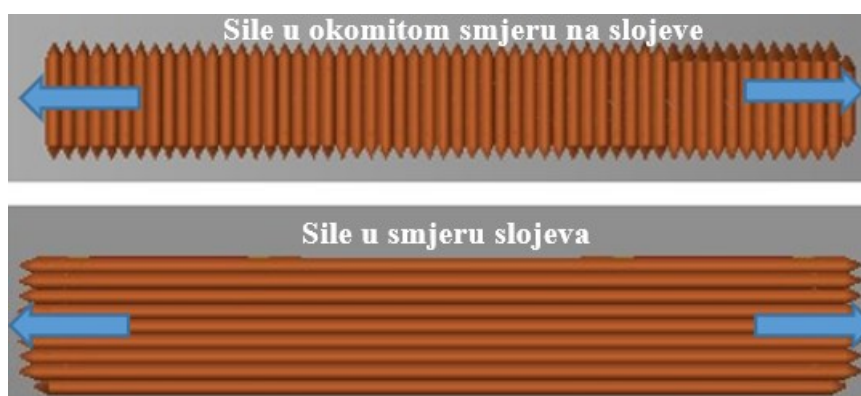
Slika 11. Smjer djelovanja naprezanja s obzirom na orijentaciju slojeva
