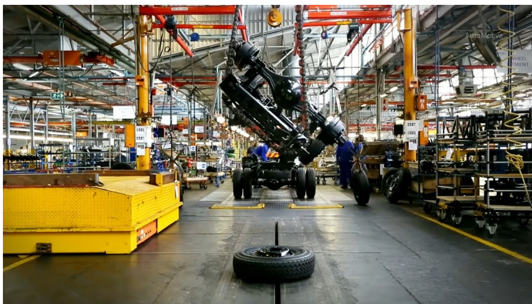
Slika 11. Okretanje šasije kamiona pomoću lanaca, ISUZU tvornica, Japan [7]
