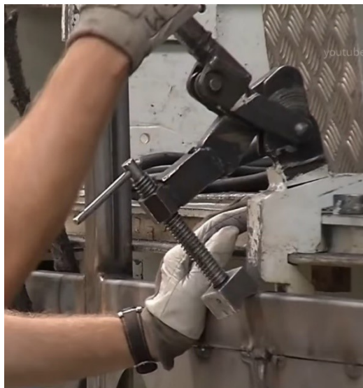
Slika 18. Tlačna stega za osiguravanje položaja dijelova rešetke tijekom zavarivanja, MAN tvornica, Poljska [3]
