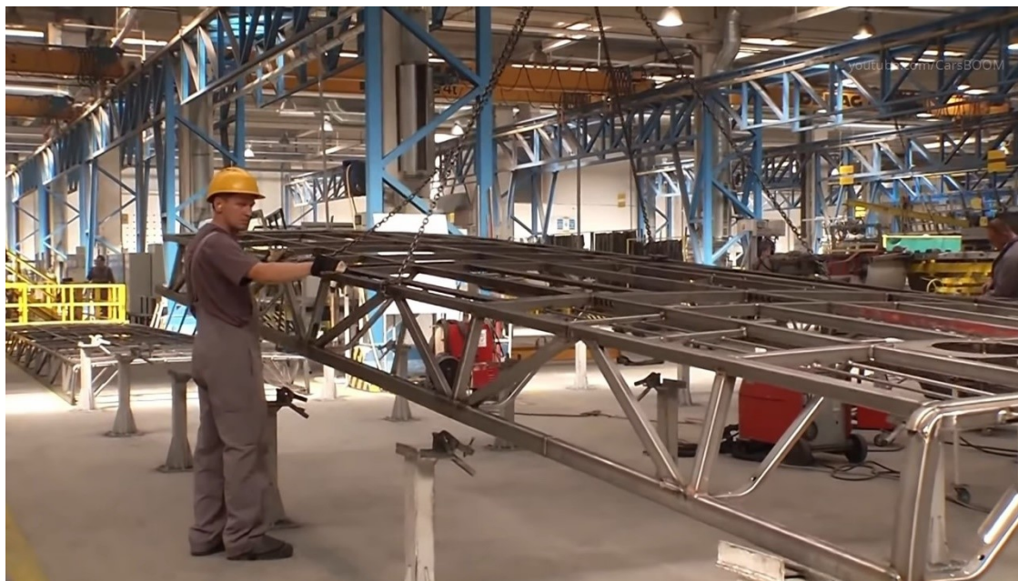
Slika 2. Pozicioniranje gornjeg dijela rešetke autobusa, MAN tvornica, Poljska [3]
