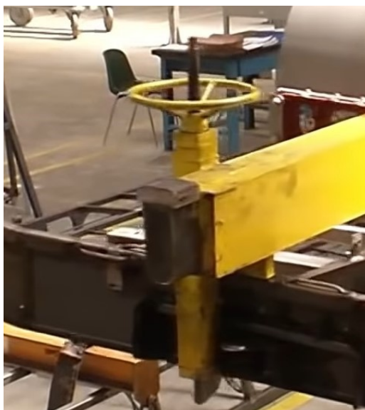
Slika 19. Vijčana stega na napravi za prijevoz i dizanje dijelova rešetke autobusa, MAN tvornica, Poljska [3]
