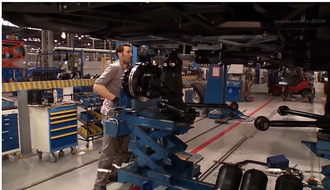
Slika 9. Postavljanje ovjesa autobusa pomoću hidrauličke naprave, MAN tvornica, Poljska [3]
