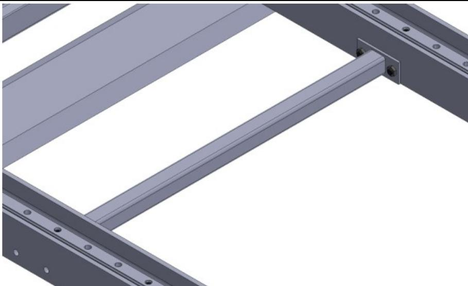
Slika 37. Spoj poprečne grede na nosače
