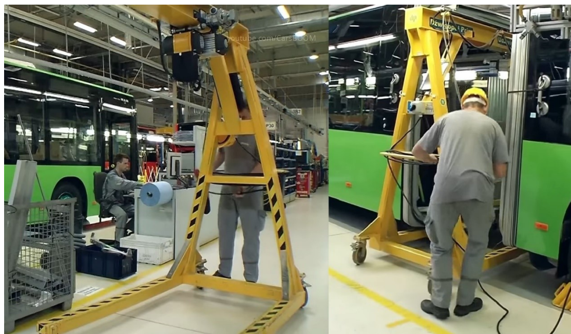
Slika 5. Naprava za međusobno pozicioniranje dijelova zglobnog autobusa, MAN tvornica, Poljska [3]
