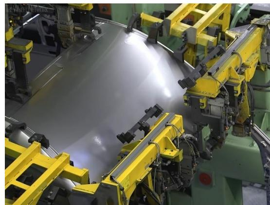
Slika 24. Robotske hvataljke na napravi za zavarivanje [11]
