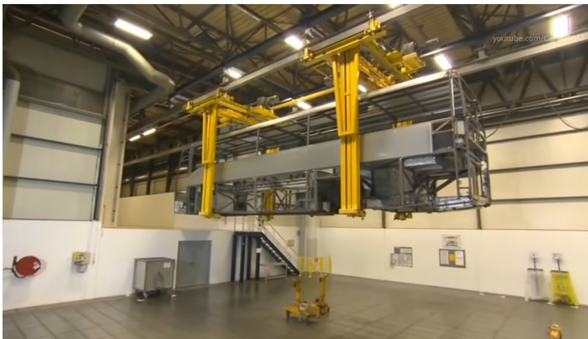
Slika 15. Prijevoz rešetke autobusa pomoću mosnih granika, Mercedes-Benz tvornica, Turska [4]
