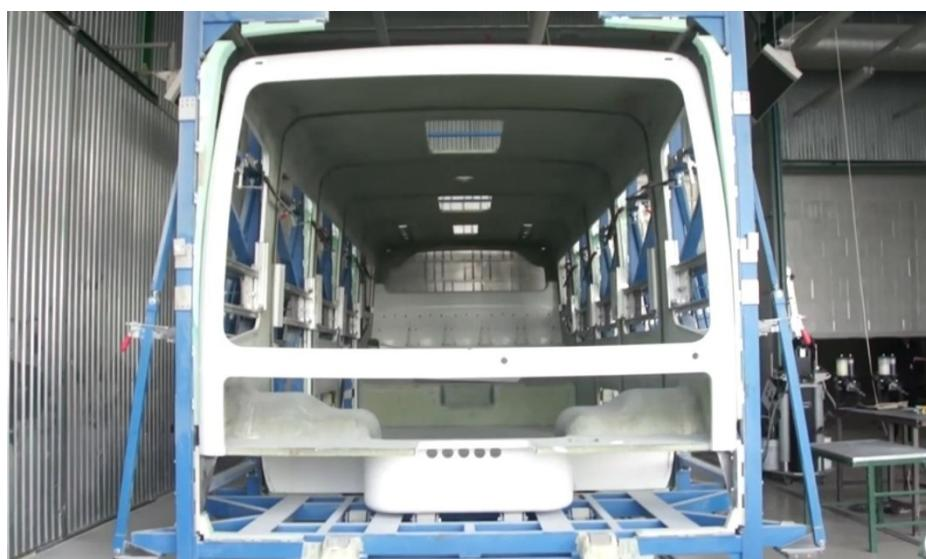
Slika 1. Naprava za spajanje modula autobusa [2]
