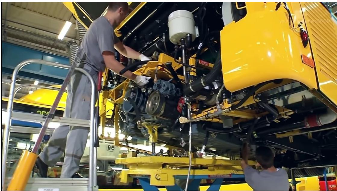
Slika 4. Pozicioniranje motora unutar autobusa, MAN tvornica, Poljska [3]
