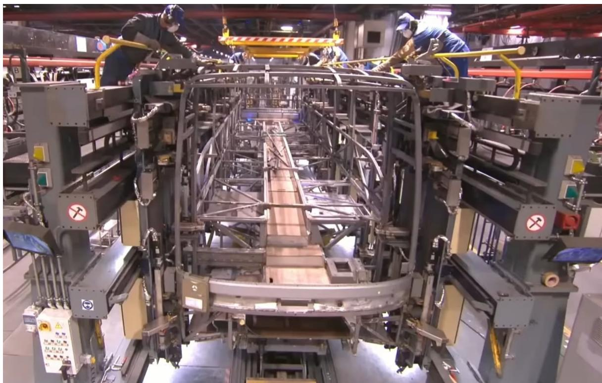
Slika 3. Spajanje dijelova rešetke autobusa, Mercedes-Benz tvornica, Turska [4]
