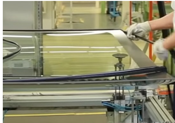
Slika 22. Stol s vakumskim elementima za prihvat stakla [11]
