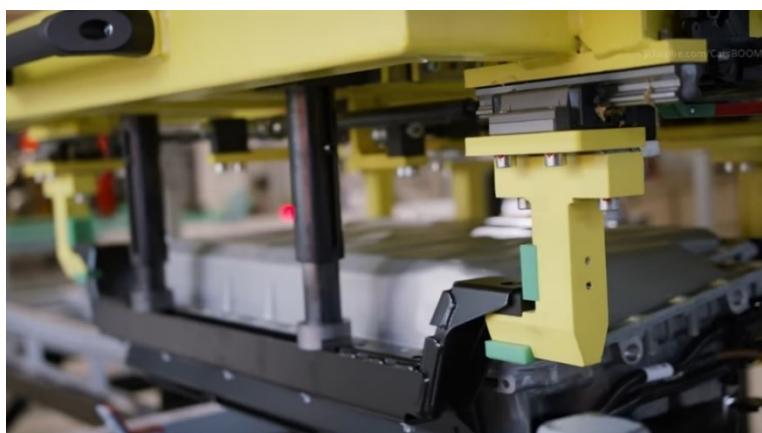
Slika 25. Hvataljke sa hidrauličkim cilindrima [13]
