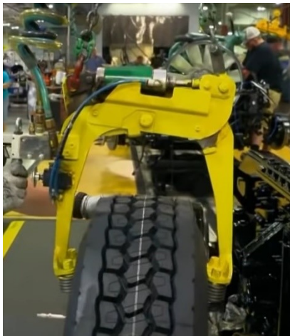
Slika 23. Hvataljke za prihvat kotača na napravi za dizanje [12]
