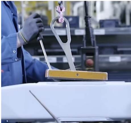
Slika 21. Vakumski prihvat na napravi za dizanje [5]
