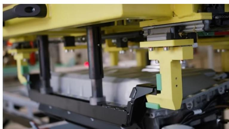
Slika 25. Hvataljke sa hidrauličkim cilindrima [13]
