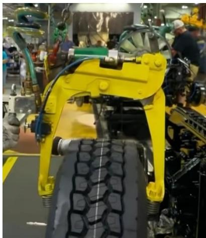
Slika 23. Hvataljke za prihvatanje kotača na napravi za dizanje [12]
