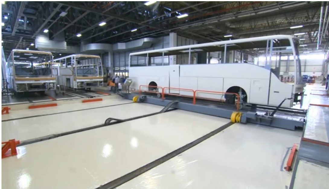
Slika 16. Prijevoz sklopa autobusa kroz pogon, Mercedes-Benz tvornica, Turska [4]
