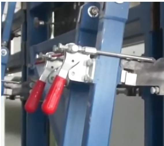
Slika 17. Vlačne stege za osiguravanje položaja na napravi mađarskog proizvođača MODULO [2]
