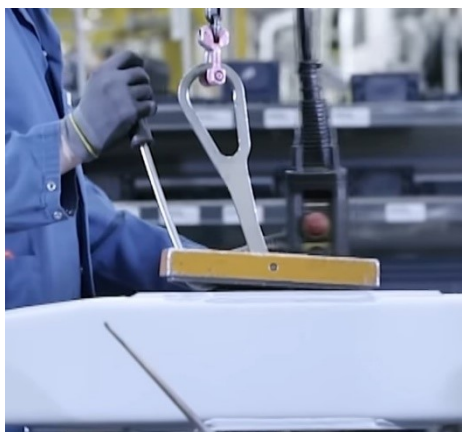
Slika 21. Vakumski prihvat na napravi za dizanje [5]
