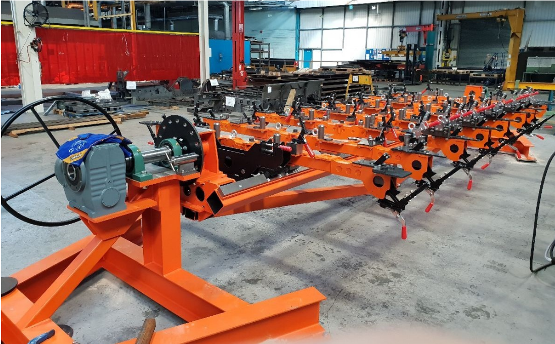
Slika 14. Stol za zavarivanje šasije proizvođača Skapandi [9]
