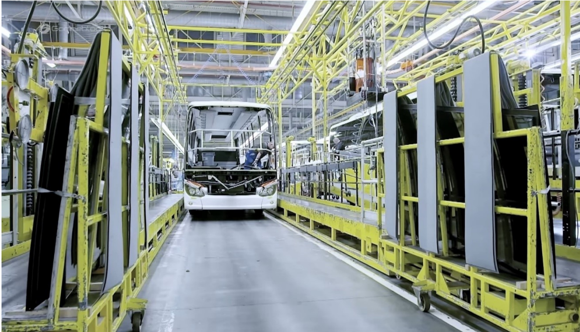
Slika 6. Naprave za postavljanje stakala i limova, Mercedes-Benz tvornica, Njemačka [5]
