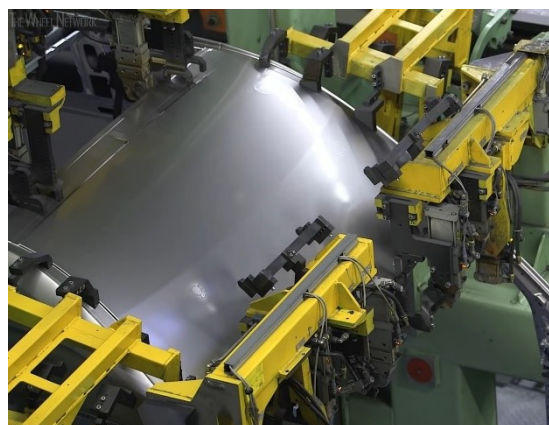
Slika 24. Robotske hvataljke na napravi za zavarivanje [11]
