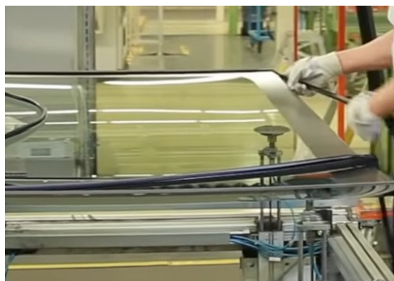
Slika 22. Stol s vakumskim elementima za prihvat stakla [11]
