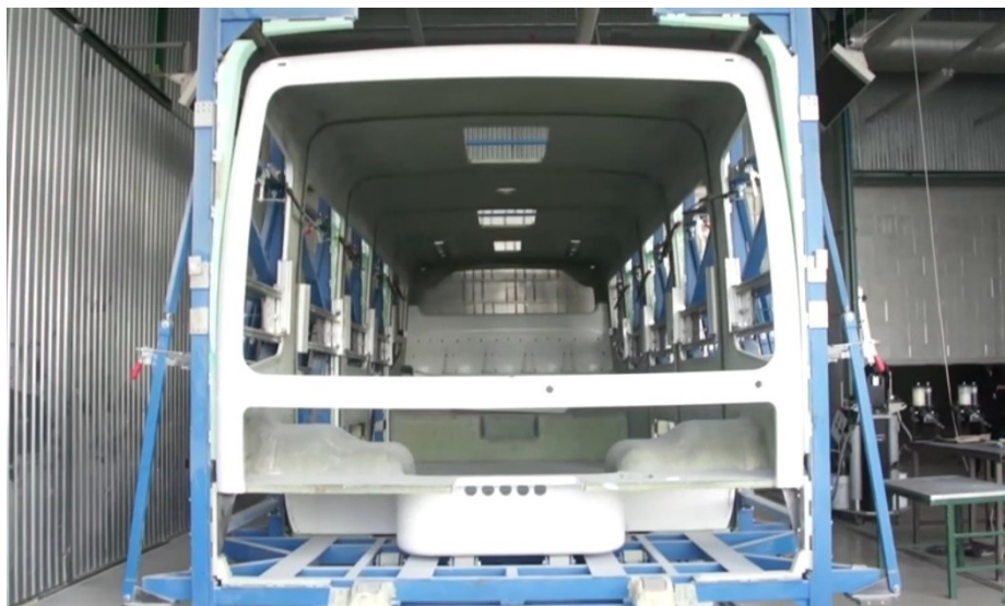
Slika 1. Naprava za spajanje modula autobusa [2]
