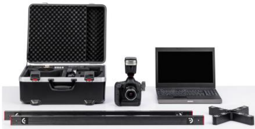
Slika 3. Komponente mjernog sustava TRITOP [9]
