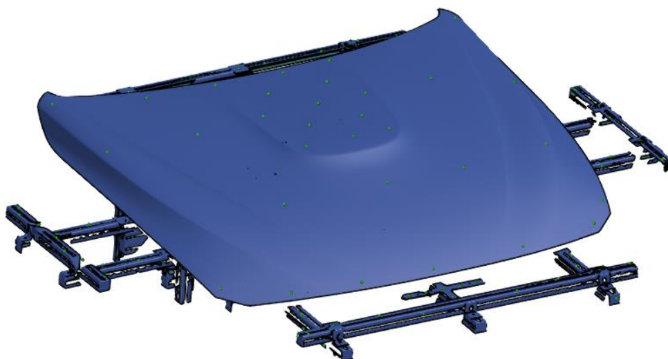
Slika 34. Nulti sken stezne naprave i haube
