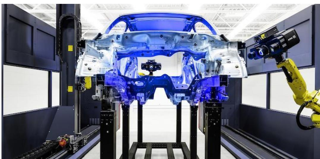
Slika 6. Kontrola karoserije ATOS 5X mjernim sustavom [11]
