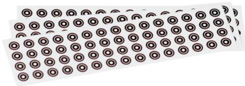
Slika 13. Samoljepljive referentne točke [12]
