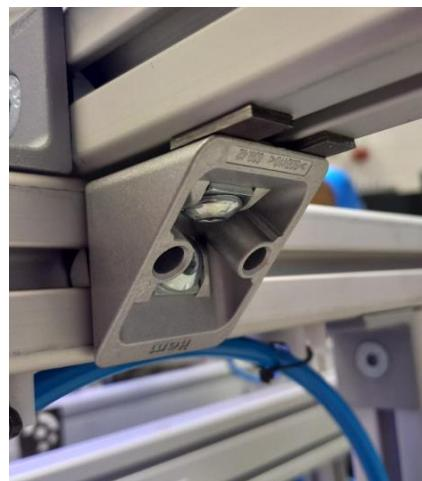
Slika 30. Pločice postavljene između kutnika i profila
