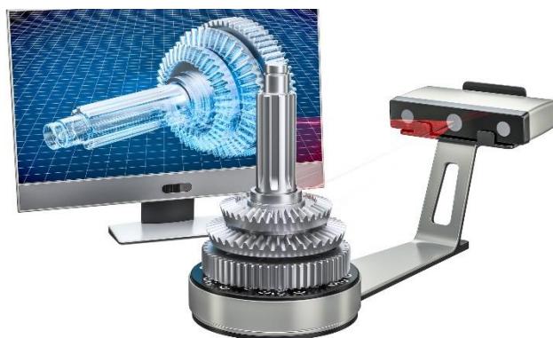
Slika 2 Proces skeniranja beskontaktnim skenerom [5]
