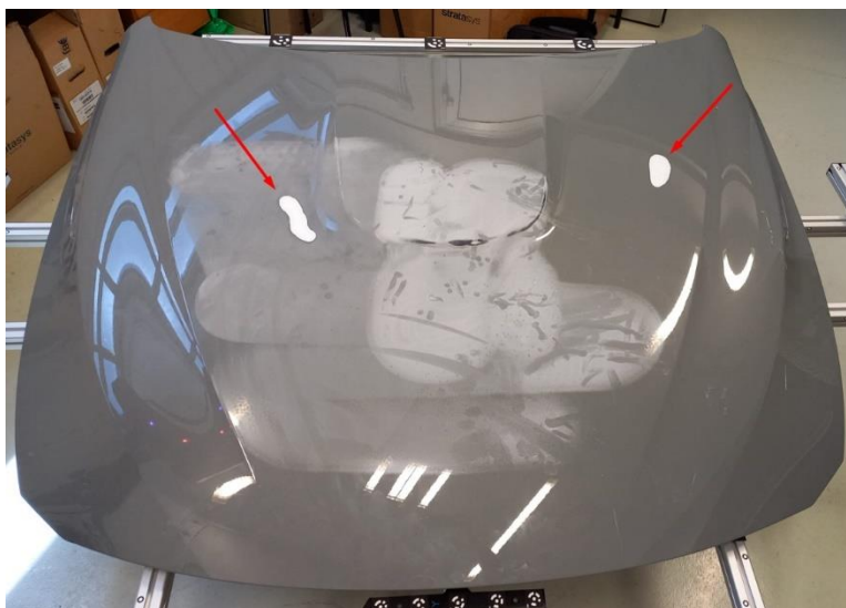
Slika 37 Postavljene spužve koje predstavljaju defekt na haubi
