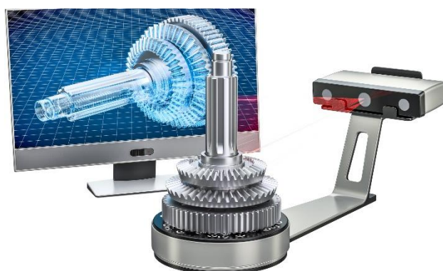
Slika 2 Proces skeniranja beskontaktnim skenerom [5]
