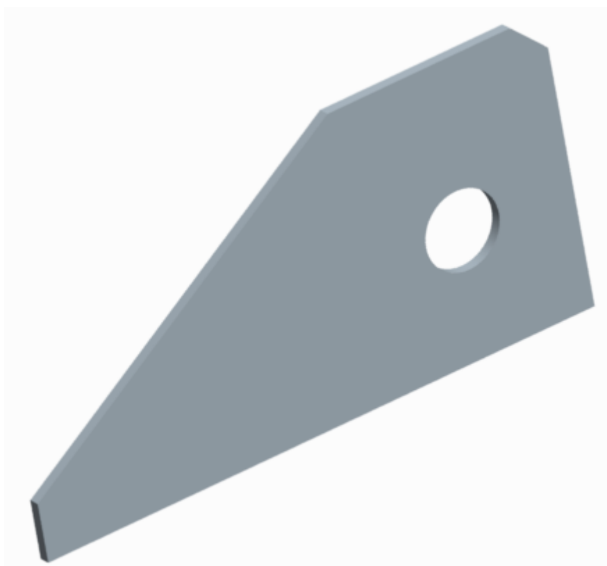
Crtež 15.Nosiva uška spremnika
