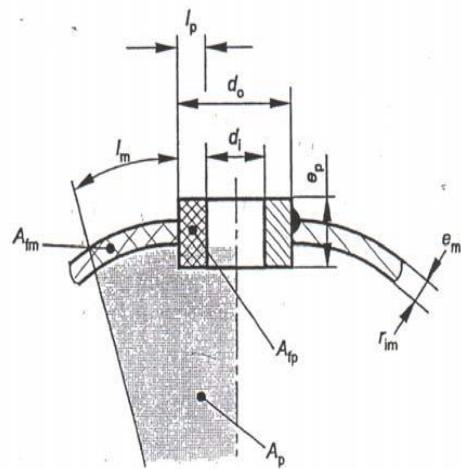
Slika 8. Ojačanje umetcima-poprečni presjek
