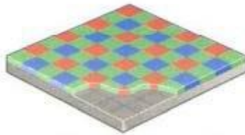
Slika 4 – Filterska mreža ispred senzora [5]
