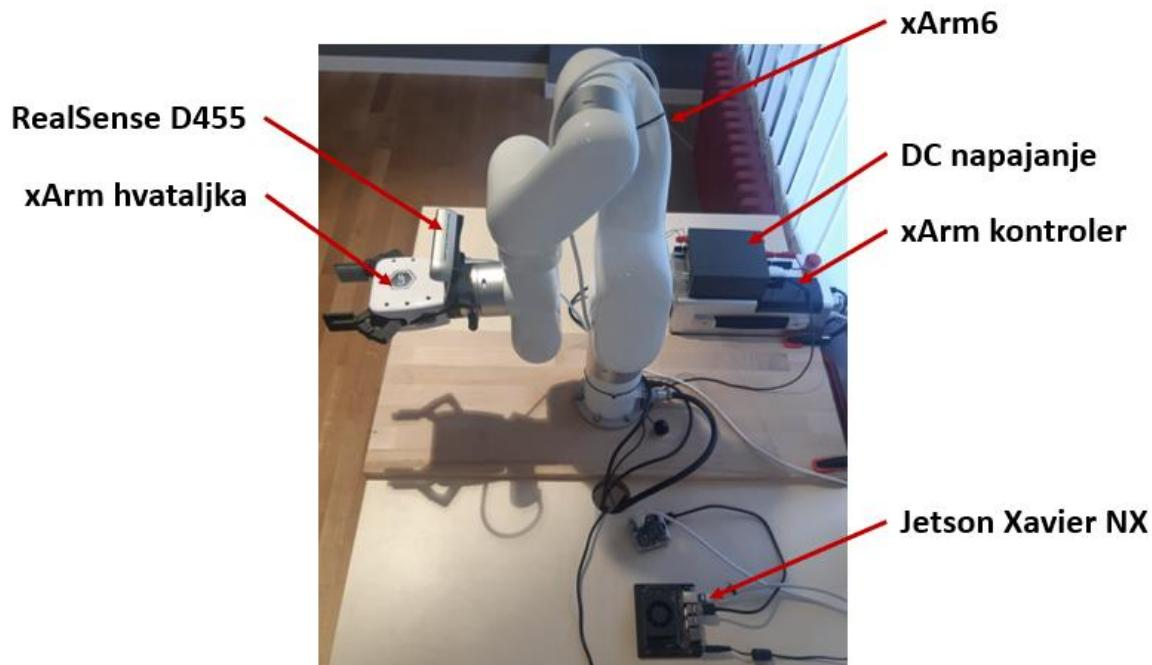
**Slika 2.1 Eksperimentalni postav sustava za manipulaciju otpadom**
