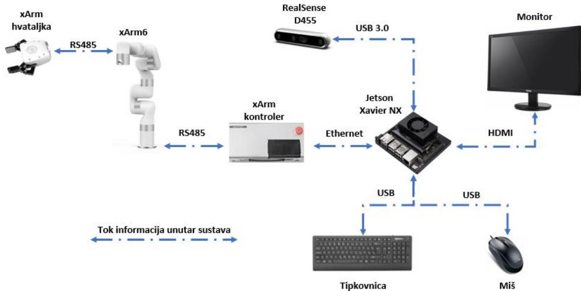
Slika 2.10 Shematski prikaz toka informacija unutar sustava
