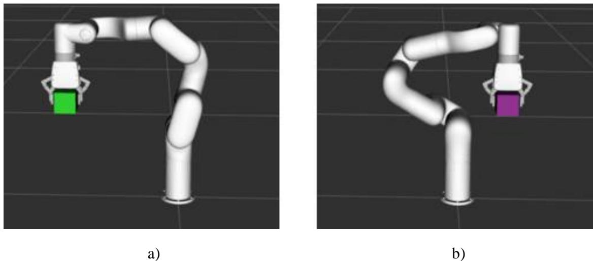
**Slika 3.23 a) Dolazak u predefiniranu točku prihvata objekta, b) Pomicanje objekta na točku odlaganja i puštanje objekta**
