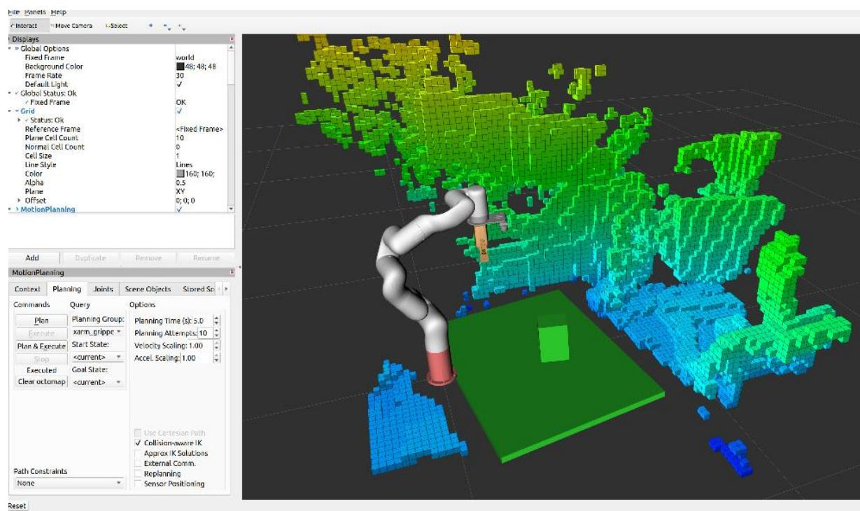
**Slika 3.21 Prikaz dodanih geometrijskih primitva u ROS okolinu kao objekti za manipulaciju**
