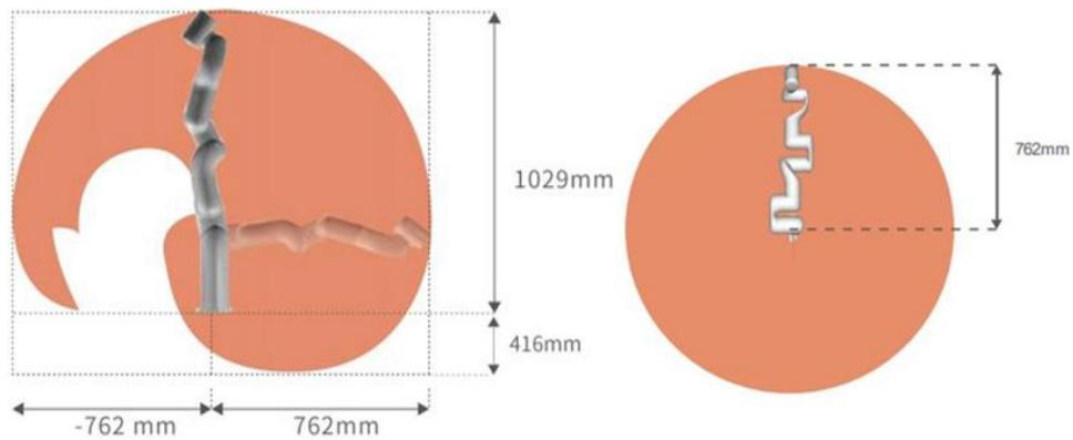
Slika 2.3 Radni opseg xArm6 robotske ruke [8]
