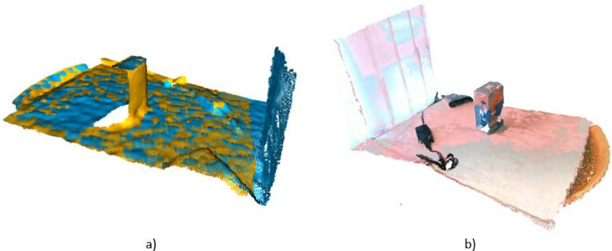
**Slika 3.17 a) Prikaz spajanja dva oblaka točaka poslije ICP registracije, b) Prikaz spajanja tri oblaka točaka**
