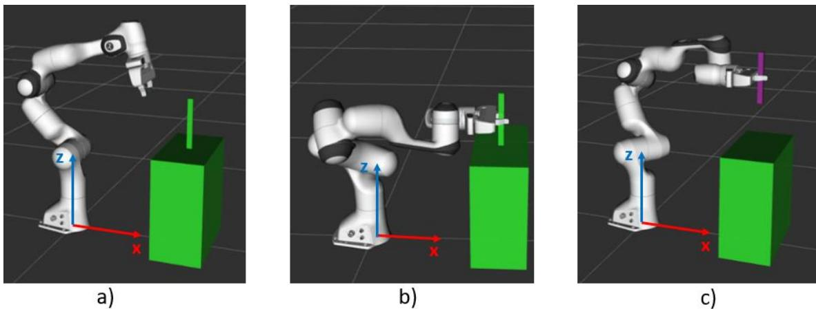
**Slika 3.24 a) Početna pozicija robotske ruke prije pozivanja metode *pick*, b) Pozivanje metode *pick* te gdje je definiran vektor prilaza objektu robotske ruke po osi x, c) Odmicanje od pozicije prihvata objekta po definiranom vektoru odmaka po osi z zajedno s objektom**
