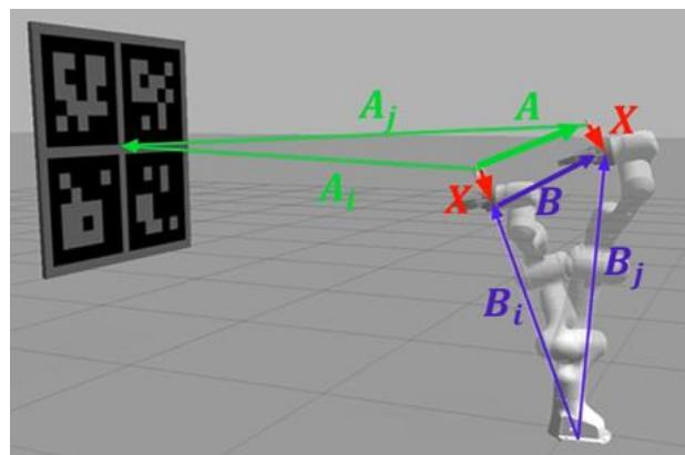
**Slika 3.10 Prikaz kalibracijskog postupka Eye in Hand kalibracije [23]**
