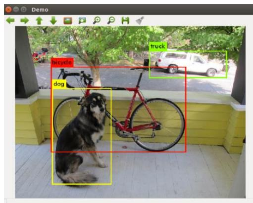
**Slika 3.11 Detekcija objekata na slici pomoću YOLO mreže [25]**
