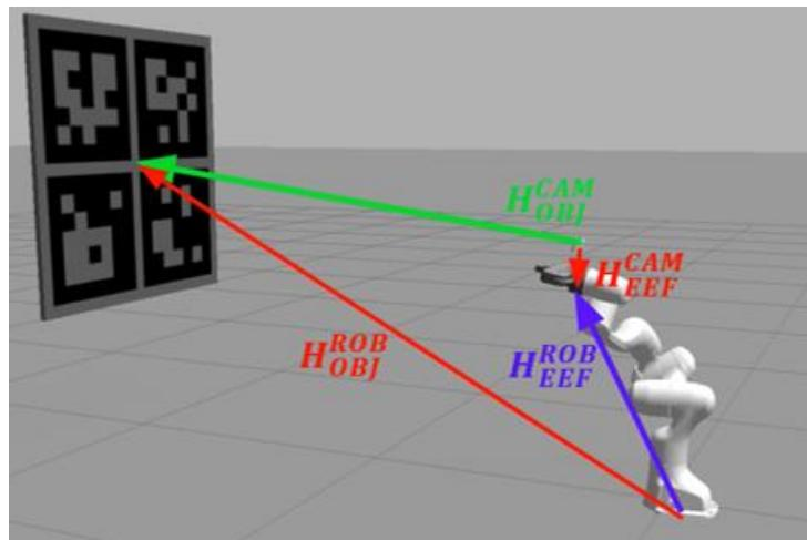
**Slika 3.8 Prikaz homogenih transformacija Eye in Hand kalibracije [23]**
