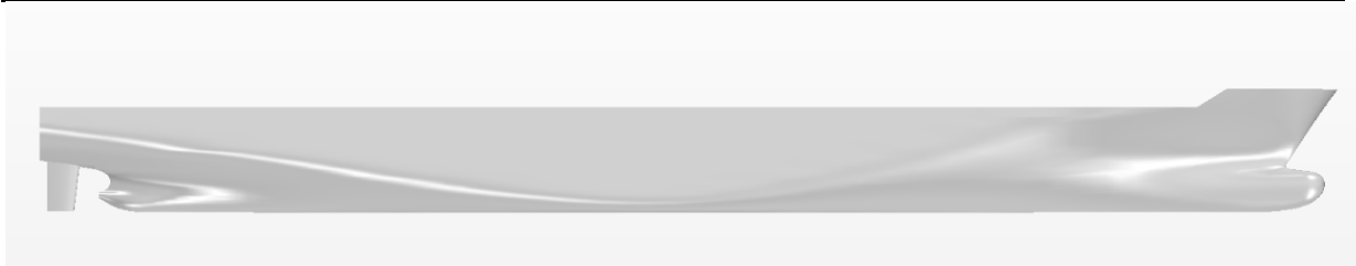
Slika 10. 3D model 6750-TEU kontejnerskog broda
